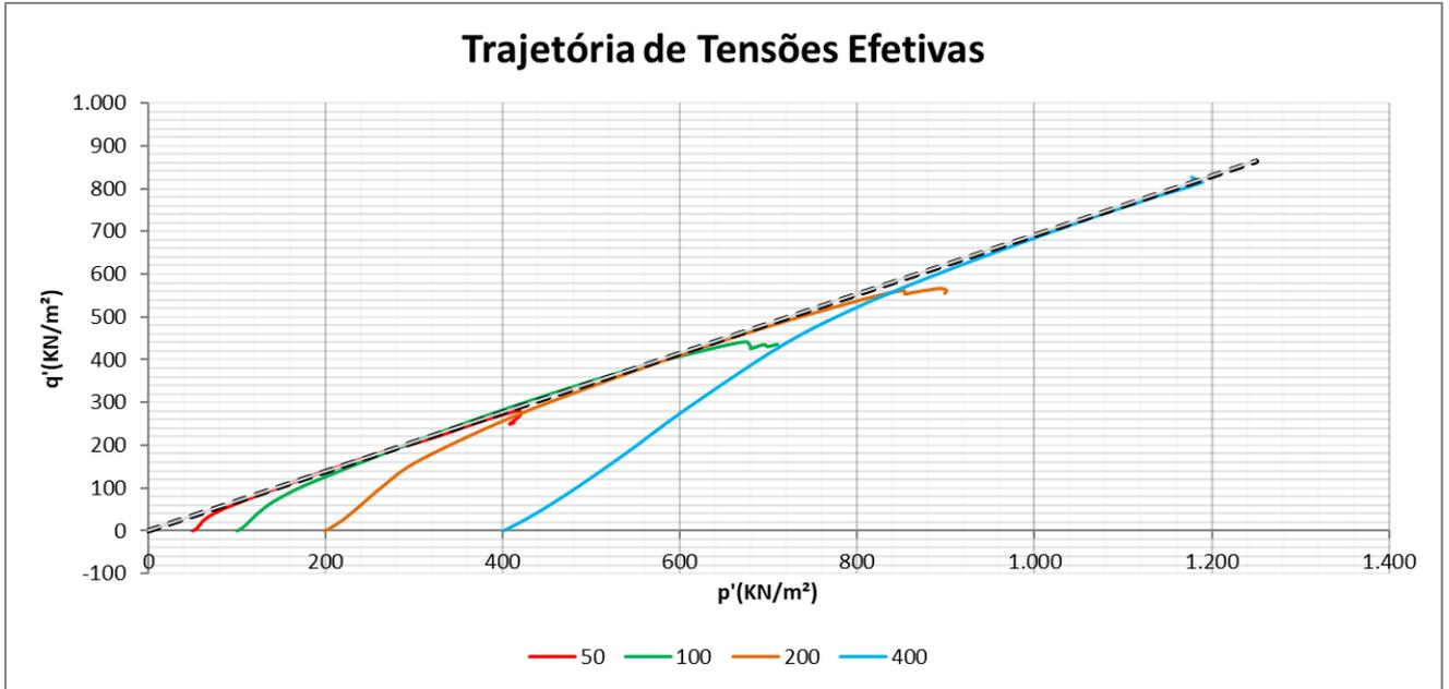
Figura 6.6 – Trajetória de tensão efetiva definida a partir do ensaio triaxial CIU – Pilha 1.
