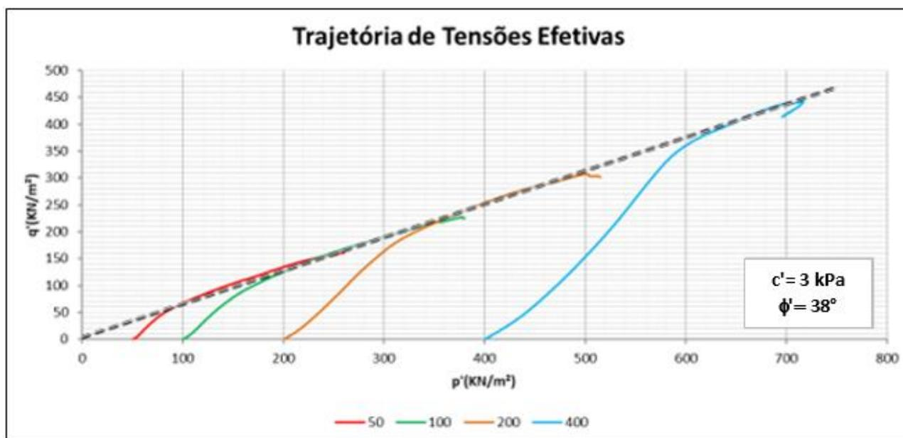
Figura 6.26 – Parâmetros de resistência efetivas definidos a partir da envoltória de ruptura definida a partir da máxima tensão desviadora.
