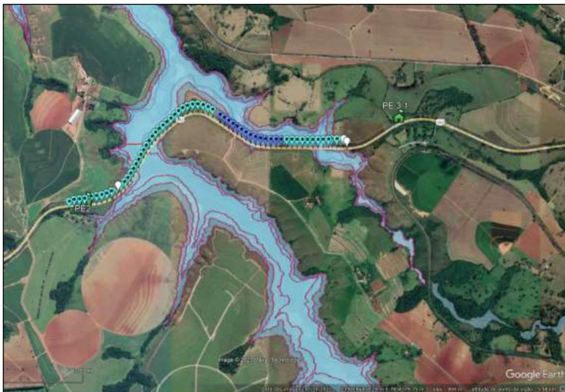
Figura 3 – localização das placas de sinalização de emergência solicitadas para instalação e as manchas de inundação das estruturas B1B4, B5, BA0 e B6, que rompem no vale do rio Capivara
