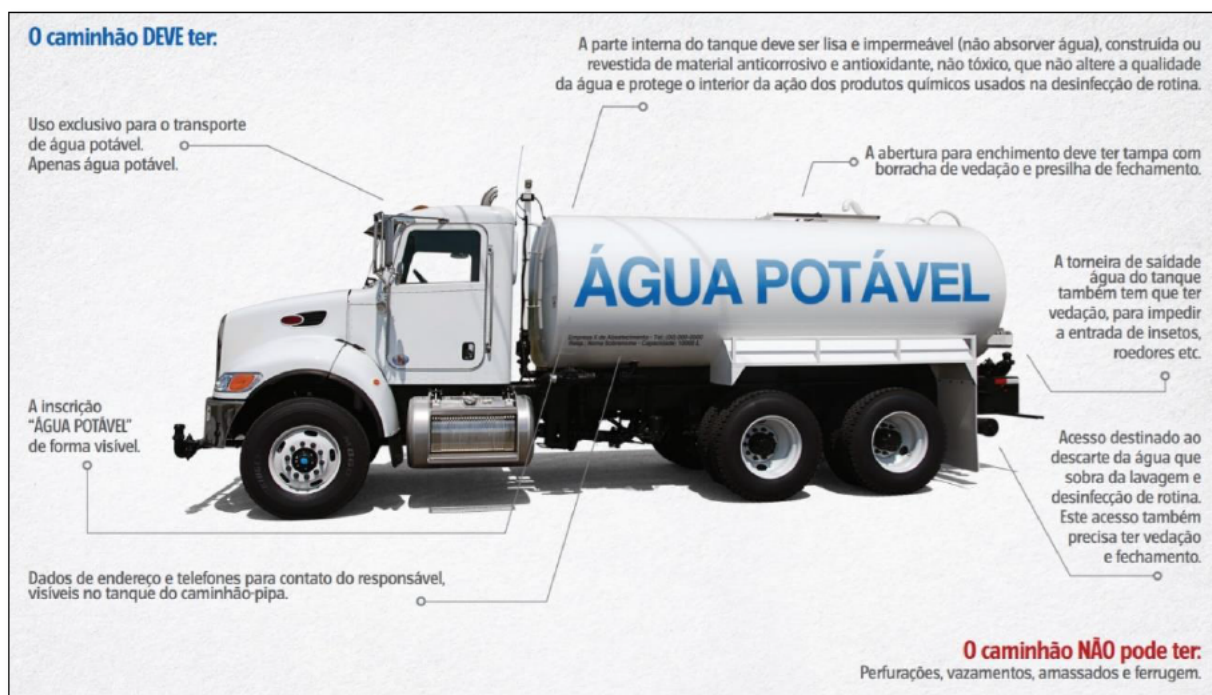
Figura 8: Características do veículo transportador de água para consumo humano
