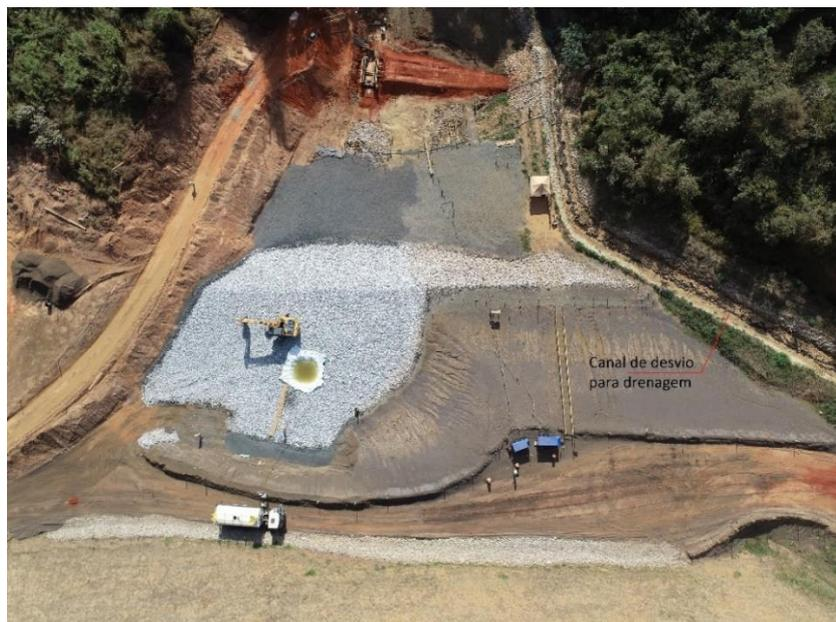
Figura 5.1.5 – Vista aérea da fundação da barragem B5
