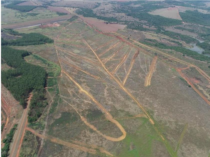
Figura 5.1.4 – Sistema de drenagem através de canais com direcionamento para sistema de bombeamento acima
