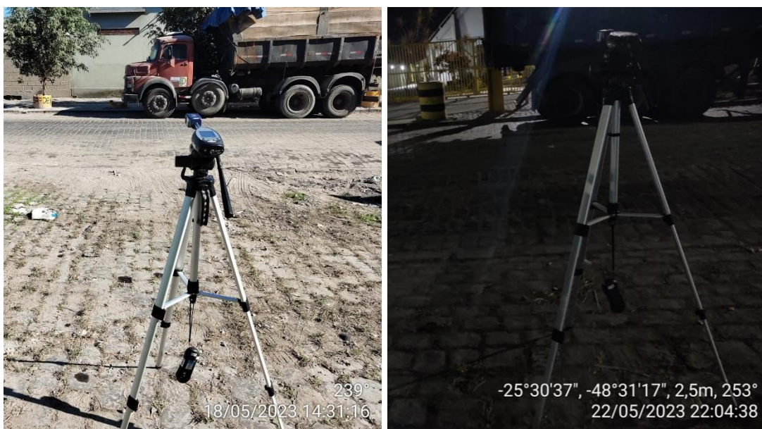
Figura 3: Ajuste do medidor de nível de pressão sonora.
