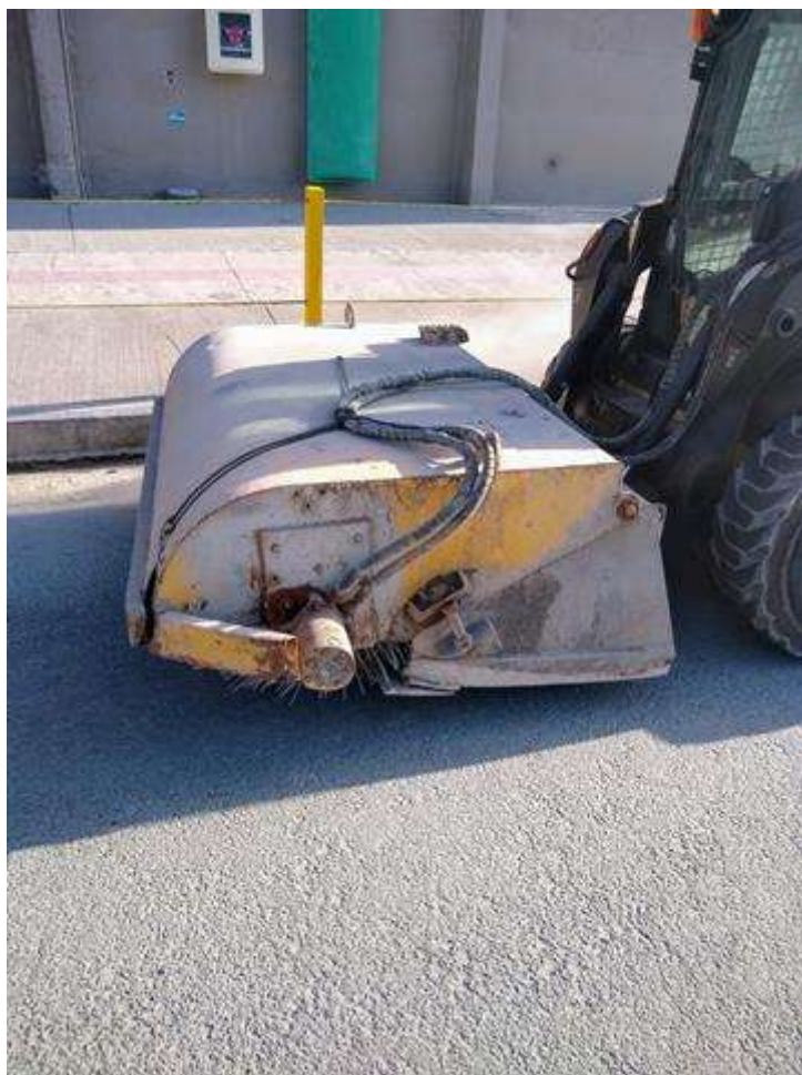
Figura 1 – Limpeza de ruas de fábrica, realizada com Bob cat com implemento de vassoura recolhadora.
