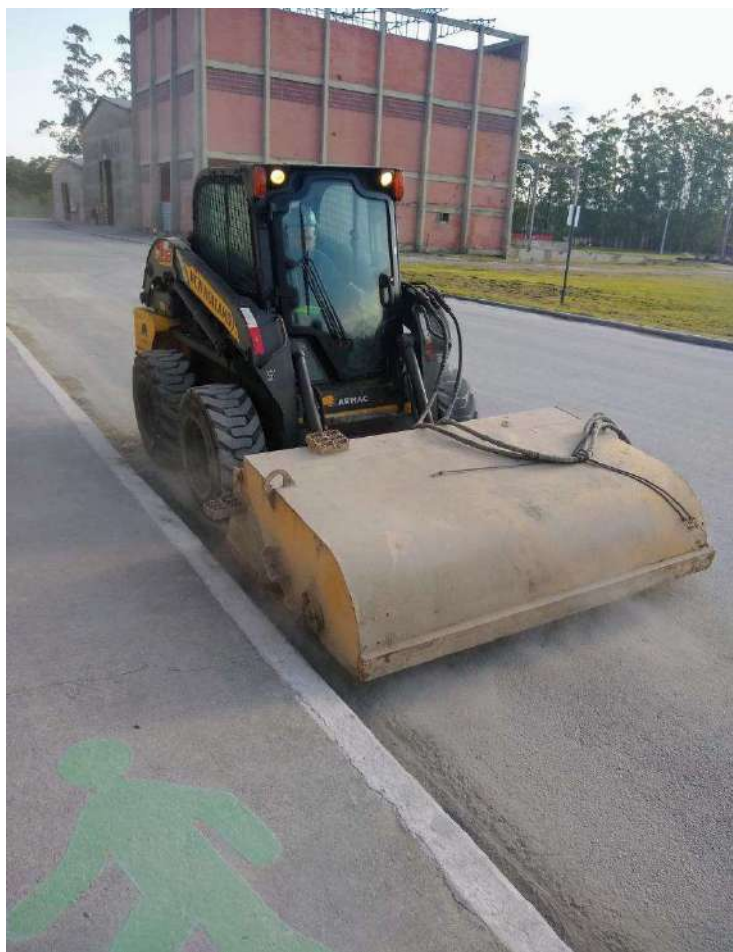
Figura 5 – Limpeza de ruas de fábrica, realizada com Bob cat com implemento de vassoura recolhadora.
