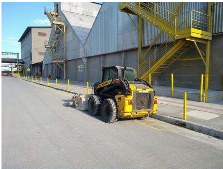
Figura 3 – Limpeza de ruas de fábrica, realizada com Bob cat com implemento de vassoura recolhadora.
