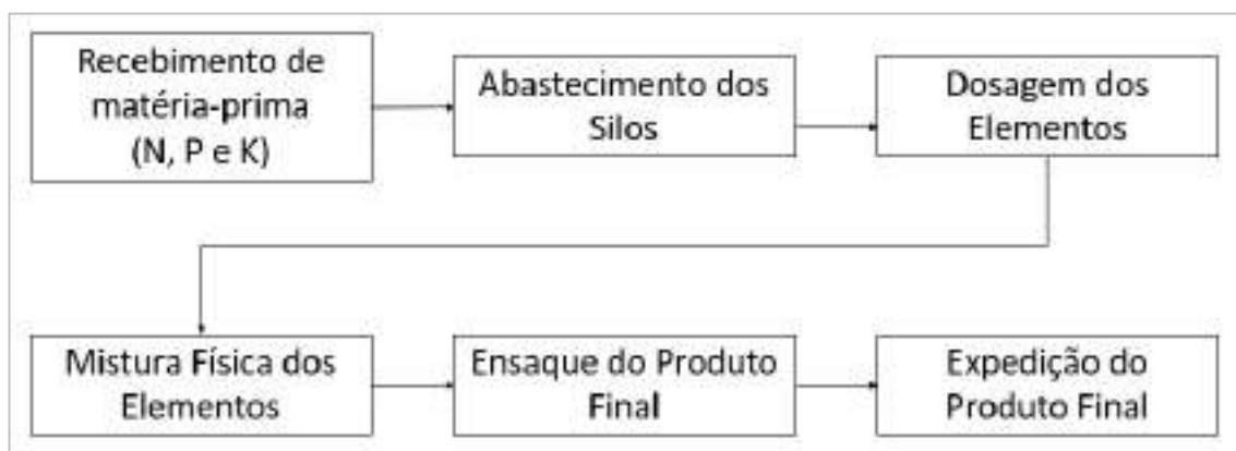
Diagrama 5.2.3.1-1 – Processo produtivo dos fertilizantes sólidos
