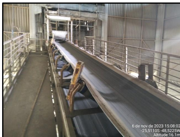
Figura 10 – Correia transportadora, que leva o fertilizante até os caminhões.
