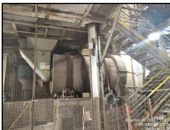
Figura 9 – Misturador, que realiza a mistura da matéria prima.
