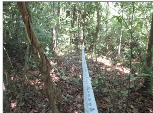
**Foto 8.4** – Demarcação de unidade amostral com auxílio de trena métrica no eixo central da parcela.
