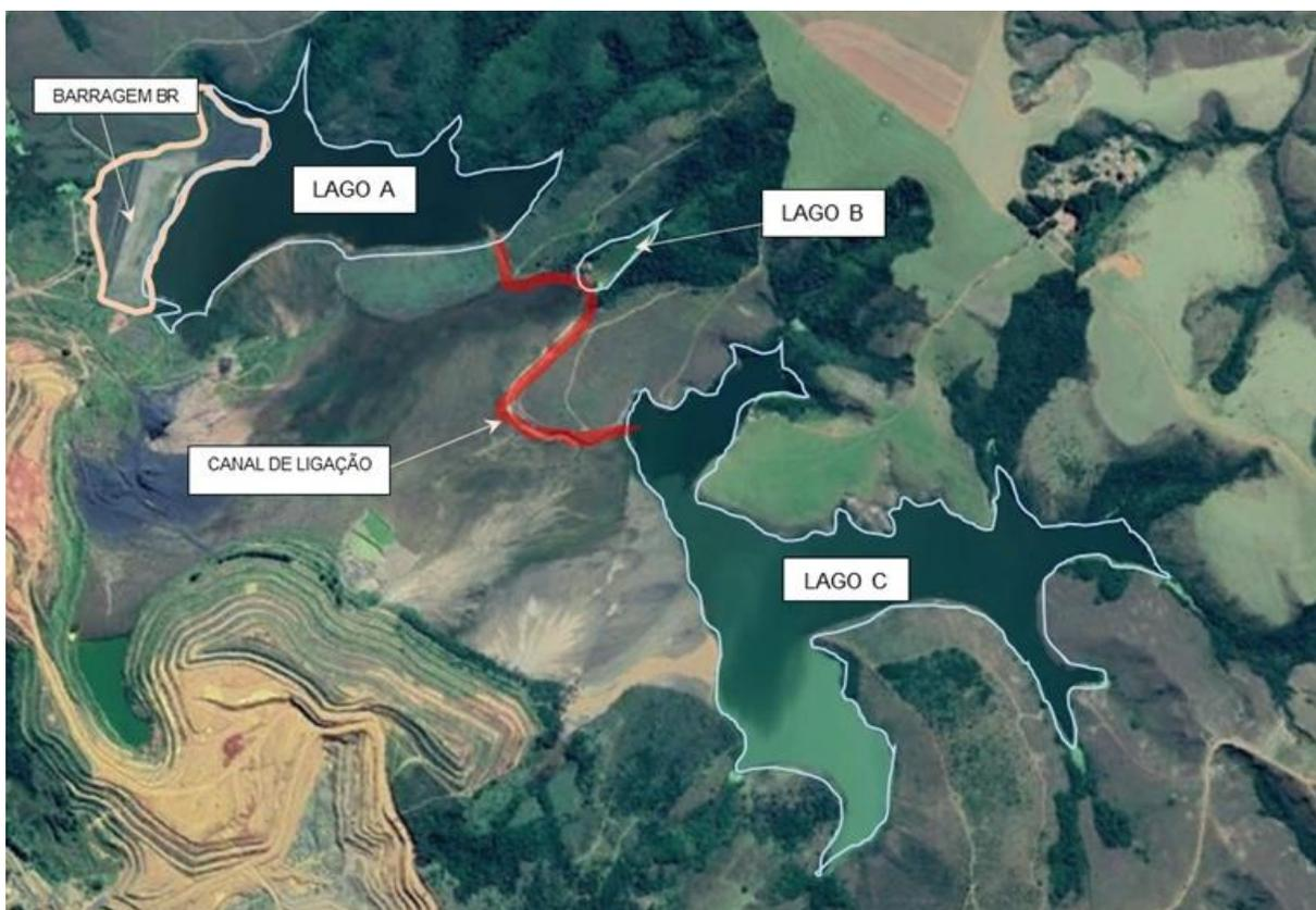
**Figura 2.1 – Barragem BR dividida em dois lagos e área de disposição de rejeitos.**
