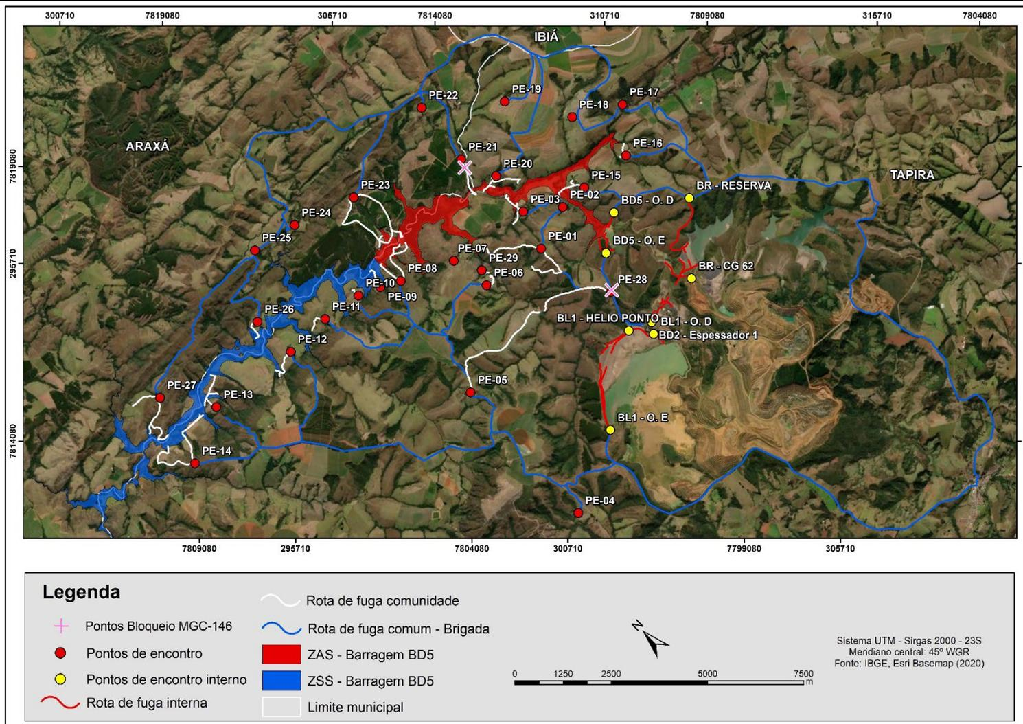
Figura 14.7 – Pontos destinados em caso de evacuação de emergência.
