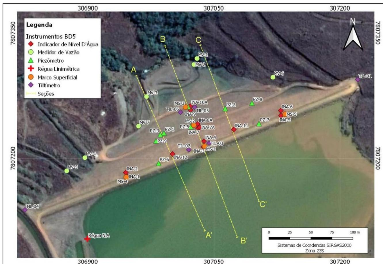
Figura 11.1 - Planta de locação da Instrumentação existente na Barragem BD5.
