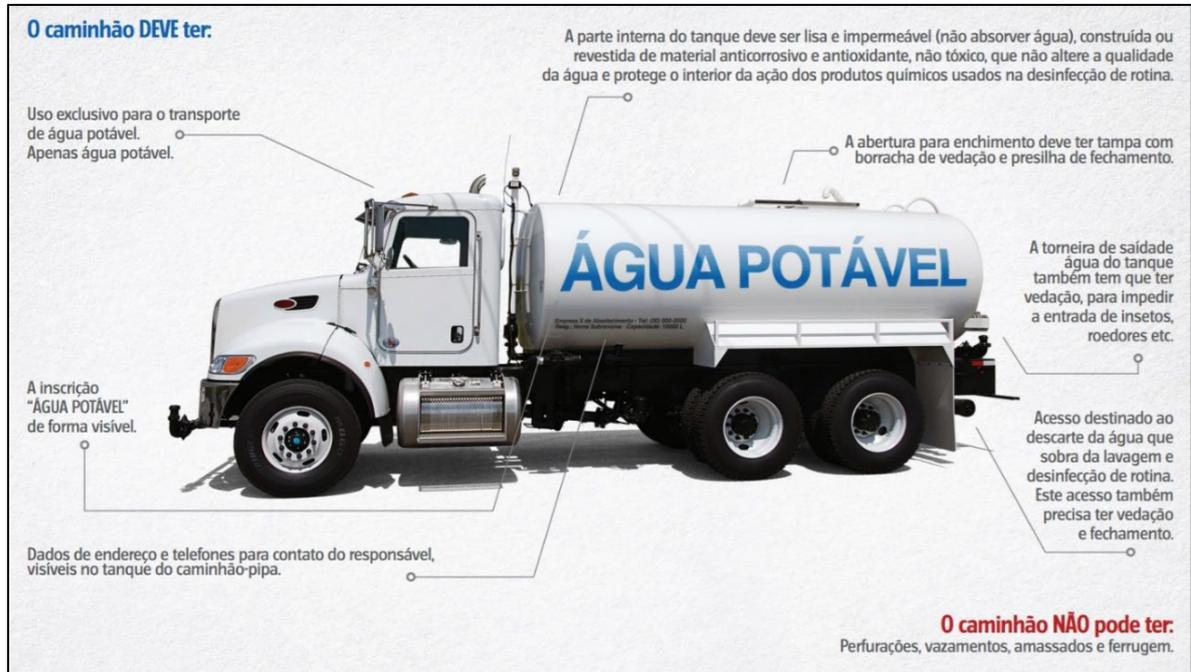
**Figura 18-5 - características do veículo transportador de água para consumo humano.**
