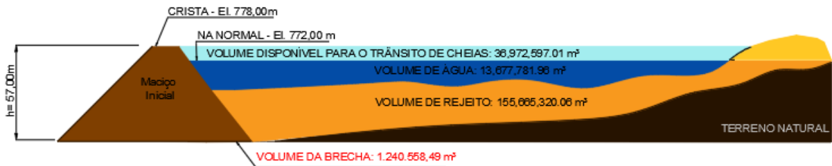
Figura 10-7 - Croqui esquemático do reservatório da Barragem BR, no evento de ruptura hipotética
