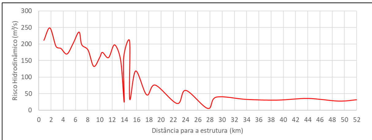
Figura 10-15 - Risco hidrodinâmico máximo nas seções representativas da Barragem BR, considerando o galgamento para cenário provável e extremo (equivalentes).
