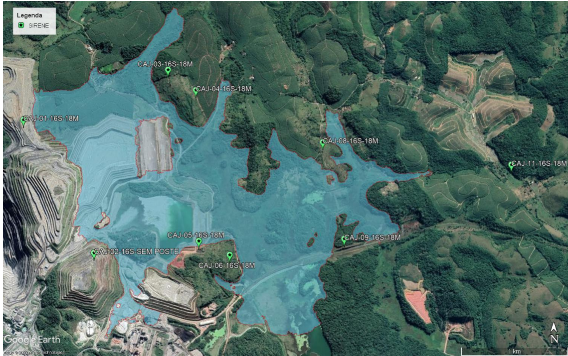
Figura 17-3 - Localização das sirenes da Barragem B2.
