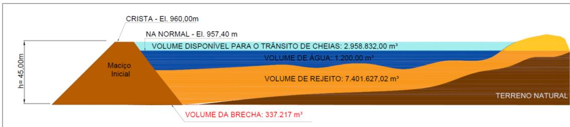
Figura 4-2 – Croqui esquemático do reservatório B6 no evento de ruptura hipotética
