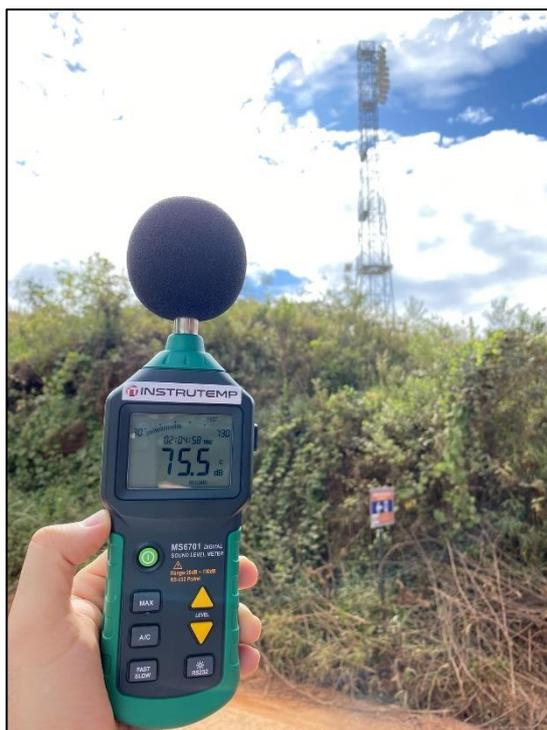
Figura 8-7 – Decibelímetro Digital Portátil utilizado pela HIDROBR para aferição
